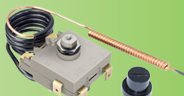
Termostato bipolare a reset manuale ad alto limite, Fail-Safe, impostazione fissa, intervallo di temperatura fino a 170°C
