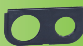
Un foro BSPP da 1"per la gamba di montaggio del tubo e un foro M25x1.5 per il pressacavo.
